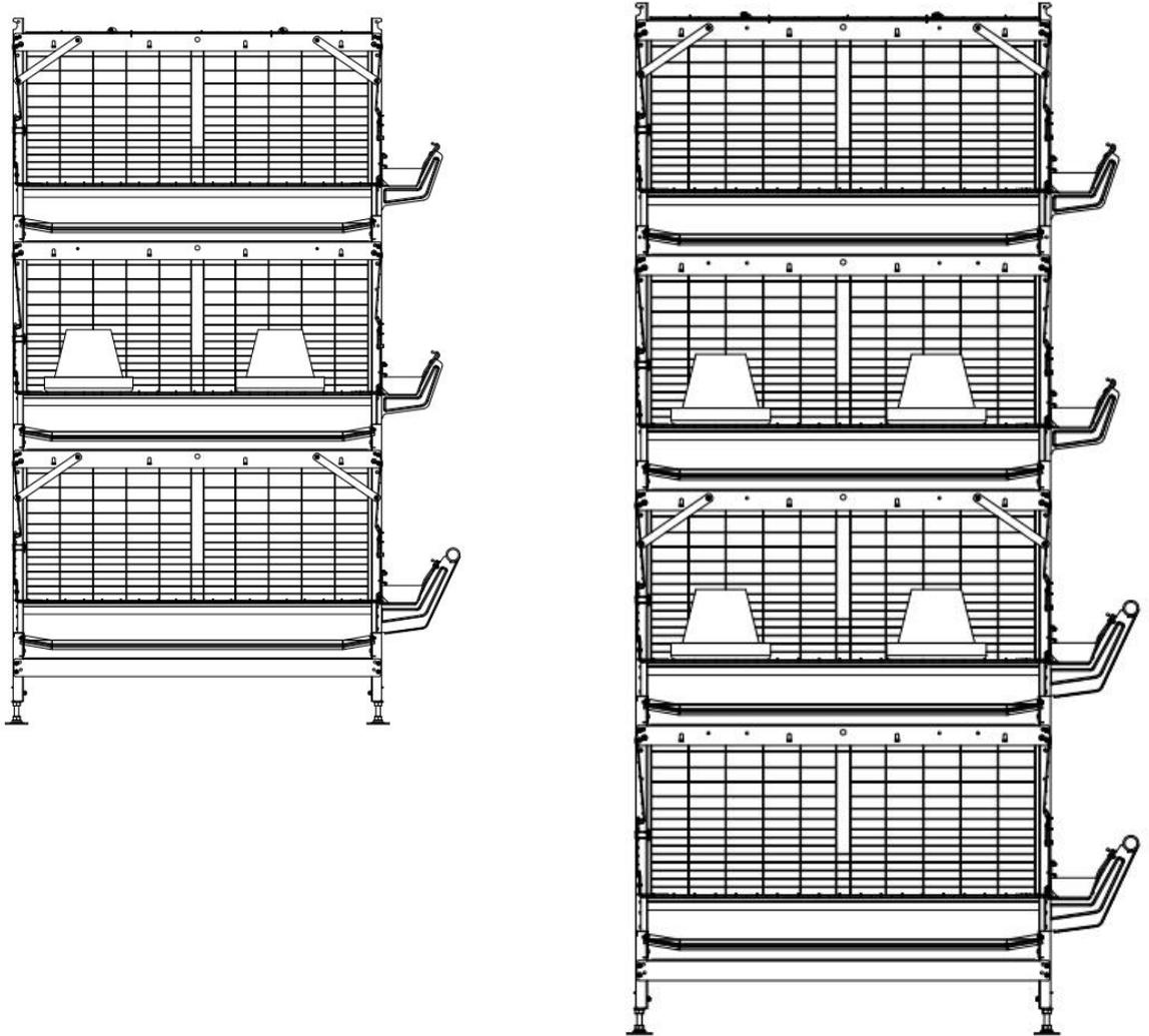
1、全套无花热镀锌板材滚压制作，尺寸一致性较高，板材耐腐蚀性能高，使用寿命长达 20 年以上；
